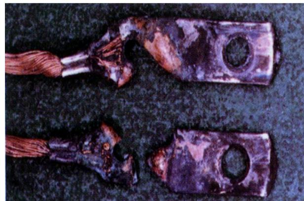
積污導電(電痕Tracking)：承受電壓之異極導體間，雖有絕緣物存在；若該絕緣物的表面附著有水分及灰塵或含有電解質之液體、金屬粉塵等導電性物質時，絕緣物的表面會流通電流及產生焦耳熱，而該帶電之附著物間，發生小規模的放電及水分之蒸發，周而復始，絕緣物表面的絕緣性受到破壞，形成異極間石墨化導電通路。多發生在插座及插頭接觸處 (刀片靠近絕緣體附近-刀片底端)
