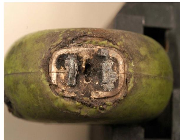
接觸不良(氧化亞銅增殖)：導線互為連接或與用電器具連接，連接處鬆弛不實，形成接觸不良，接觸電阻值增高；又接觸面不潔，有油類等絕緣物附著時，亦會增高接觸電阻值。
