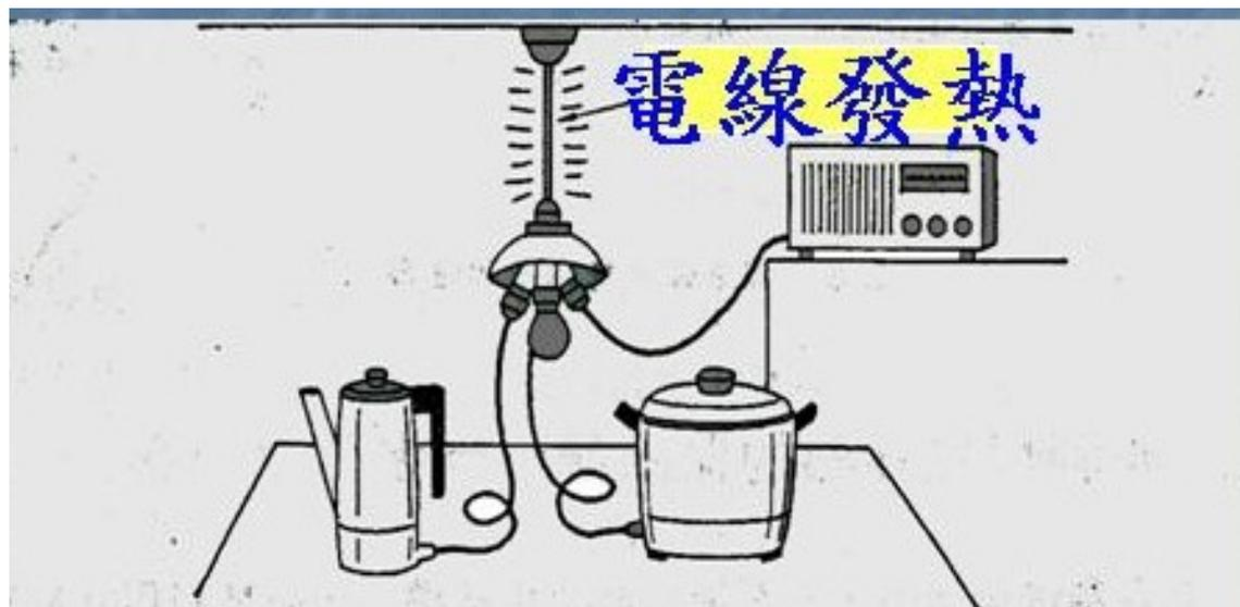
當配電回路裝接過多負載時，回路上所安裝的過電流保護裝置失效或未按導線安培容量加以保護，則導線因流通過電流，易使絕緣起火燃燒。
