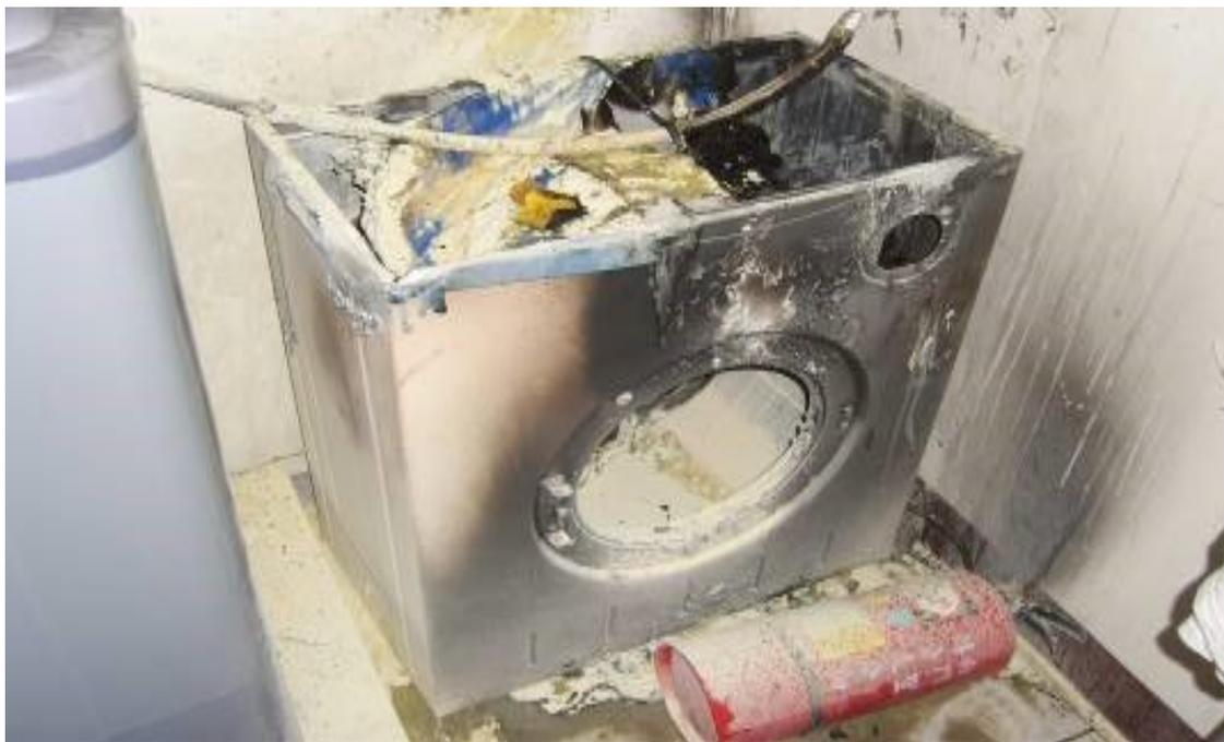
烘衣機右側燃燒最為嚴重，平常烘衣機置於廁所外面潮濕之場所，家中也有養寵物，因此插頭及插座堆積毛髮及灰塵加上水份形成通路，造成積污導電。
